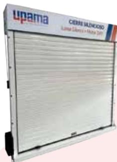
La lama **P-77 Silence** consiste en el ensamblado de dos láminas de acero mediante un polímero intermedio de dos caras. Dicho polímero absorbe la transmisión de vibraciones de los perfiles metálicos, consiguiendo reducir hasta un **80% de sonoridad** con respecto a las lamas tradicionales; dando así la solución a los clientes que requieren un sistema de seguridad silencioso.
